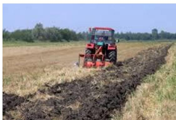
Pre zaoravanja, biljne ostatke treba isitniti radi lakšeg i ravnomernijeg unošenja u zemljište. Pored sitnilica raznih konstrukcija danas postoje i adapteri, koji se montiraju na kombajn, pa se sa žetvom
